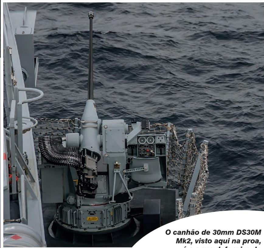
*O canhão de 30mm DS30M Mk2, visto aqui na proa, é a arma defensiva do navio. Quatro destes são controlados remotamente do COC com backup manual*
