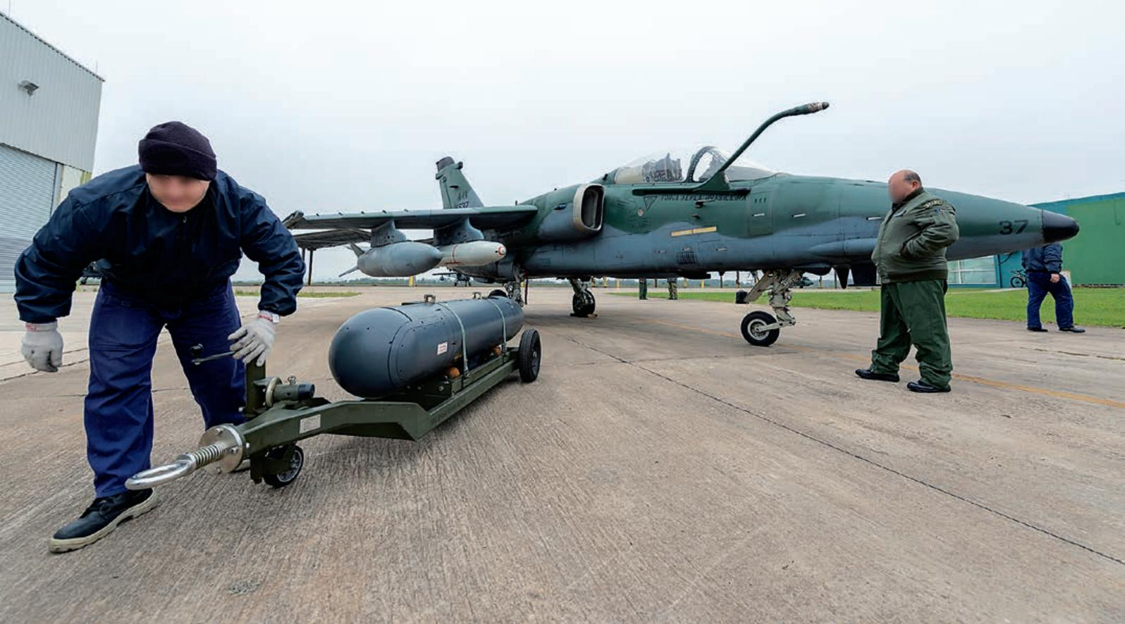
*Acima, o pessoal de solo da Ala 4 equipa com duas bombas incendiárias BINC-300 e dois tanques de combustível de 580 litros. No primeiro plano um sensor Reccelite da Rafael antes de ser instalado na posição ventral do AMX do Esquadrão Poker. Abaixo, um mecânico faz as últimas checagens antes de o AMX modernizado do Esquadrão Centauro decolar para a sua missão*
