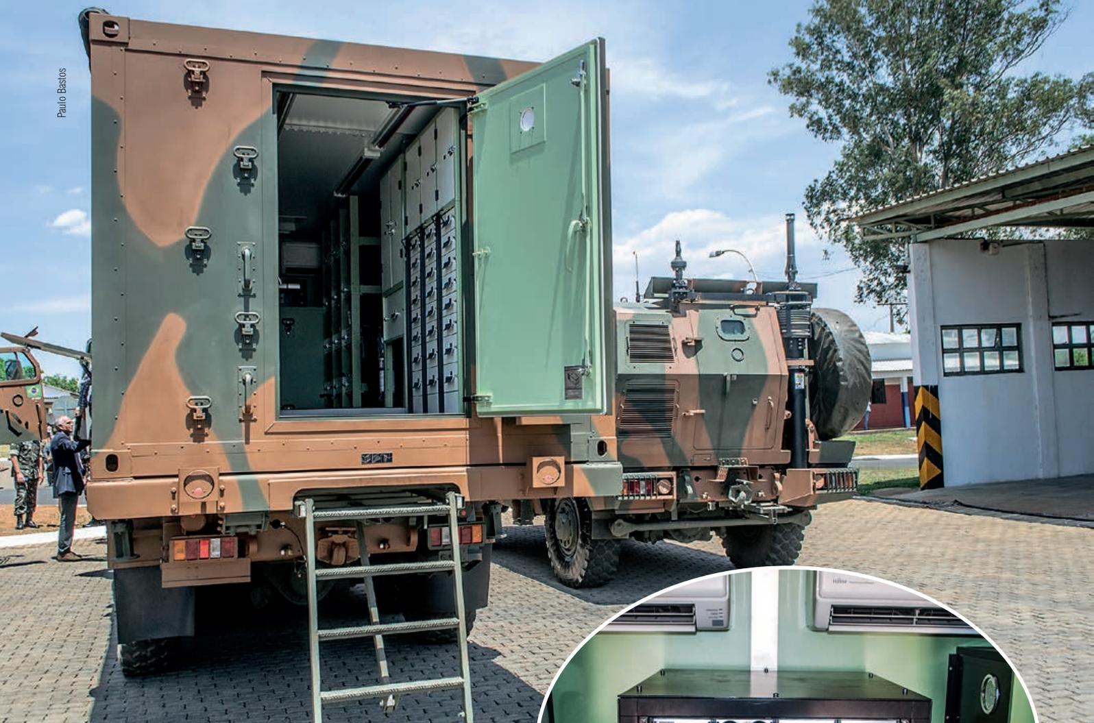
**Acima: visão traseira da viatura oficina especializada (OFVE), onde se pode ver seus compartimentos para guarda de componentes para manutenção mecânica e eletrônica. Destaque: um Smartpack da RF COM, retificador inversor AC/DC, que é um dos diversos equipamentos equipam a OFVE**
