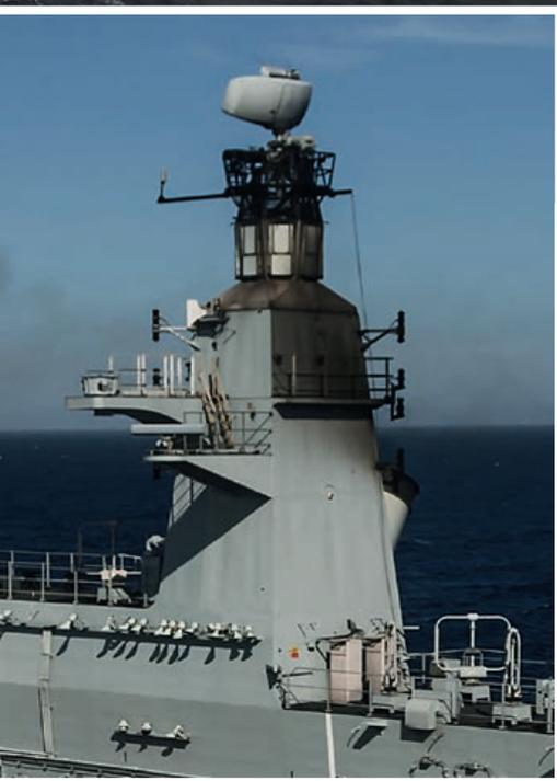
*Uma boa vista do radar digital Artisan 3D 997, com elevada capacidade de detecção e acompanhamento de alvos aéreos e controle das operações de aeronaves*
