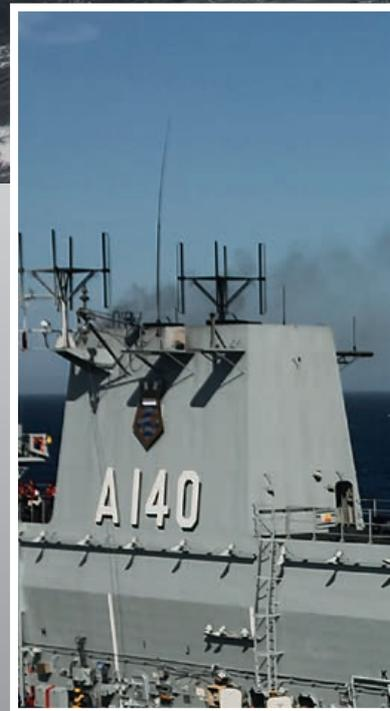
**Na proa, é possível observar o local onde estava instalado o CIWS Phalanx, de 20mm. Restou um quadrado de metal usado como base**
