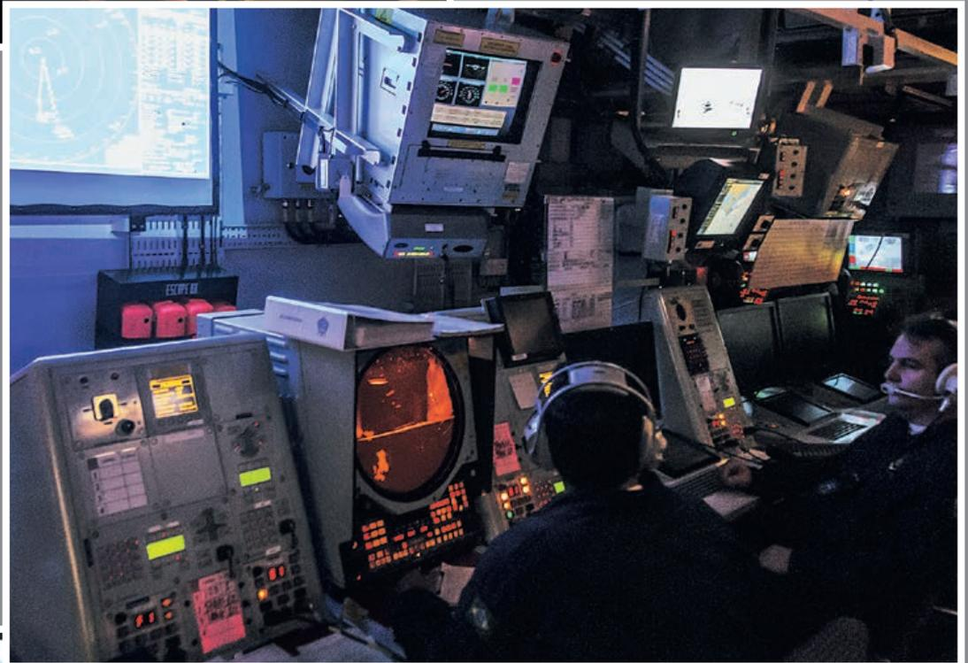
*...as telas de sensores dos operadores do COC, com destaque para o radar 3D Artisan...*
