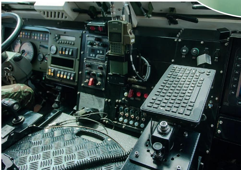
**O painel de uma viatura unidade de controle de tiro (UCF), mostrando seu avançado sistema de comunicação, padrão para todos os veículos da bateria**
