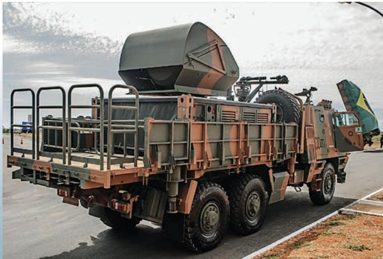
**Uma das duas unidades de controle de fogo (UCF) MK6 entregues, batizada de Hércules. As UCF da versão MK6 são equipadas com o moderno radar RAD FG-3, cujo EDT foi desenvolvido especificamente para o Sistema ASTROS II**
