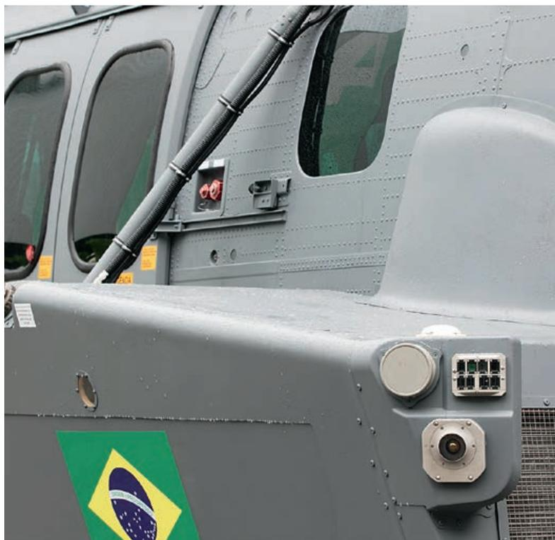
À esquerda, o míssil approach warning MAW-300 e, na foto ao lado, os três sensores instalados num H225M
