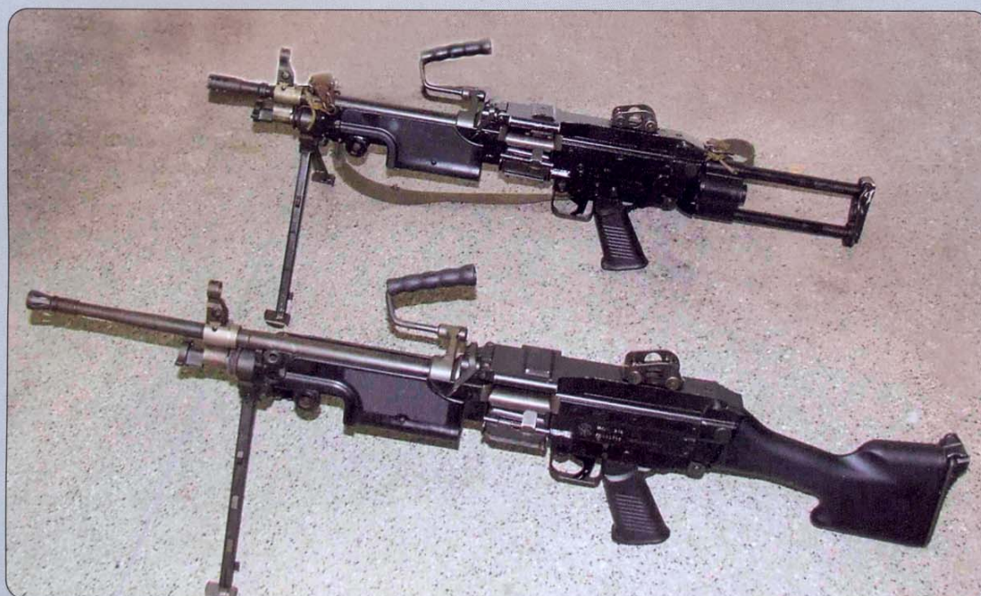
As metralhadoras leves de apoio FN Minimi (coronha sintética fixa, cano de 465 mm) e a mais compacta Minimi Para (coronha tubular retrátil, cano de 349mm), ambas em calibre 5,56 x 45mm e de fabricação belga, também fazem parte do arsenal do GruMeC
